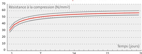
La figure donne l'évolution de la résistance à la compression sur cubes de 150 mm d'arête, obtenue dans notre laboratoire sur un béton à base du CEM I 52,5 R HES.
